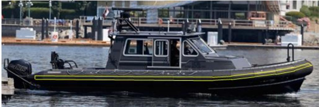
En jaune, une bande de frottement Bombard Rub Straking en un seul morceau est appliquée de la proue à la poupe.
