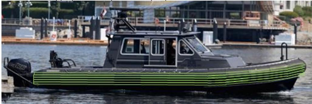
La bande de protection est composée de cinq bandes de frottement Bombard RubStraking vertes. Chaque bande individuelle est appliquée de la proue à la poupe. Les cinq pièces fixées les unes par-dessus les autres protègent 375 mm de largeur de zones à usure élevée.
