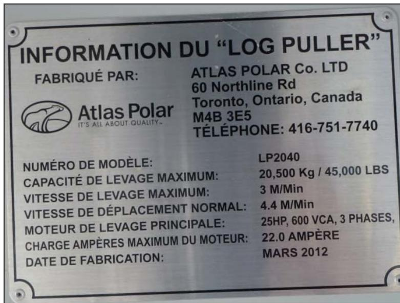
Figure 4 : Plaque signalétique du lève-poutrelles.
