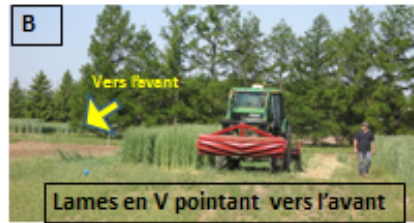
Lames en V du rouleau crêpeur orientées dans le sens de l'avancement.
